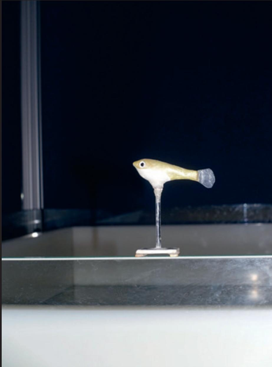
**Er zeigt dem Schwarm, wo's langgeht. Der »Robofish« des Leibniz-Instituts für Gewässerökologie und Binnenfischerei wird von Guppys als Artgenosse akzeptiert. Mal folgen sie ihm treu ergeben — mal lassen sie ihn links liegen. Der autonom schwimmende Roboter verrät den Forschern so mehr über das Schwarmverhalten im Tierreich.**
